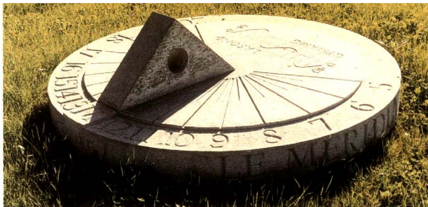
Primo piano sulla bella meridiana in pietra di Luserna: sulla destra, il grafico dell'Equazione del Tempo.
